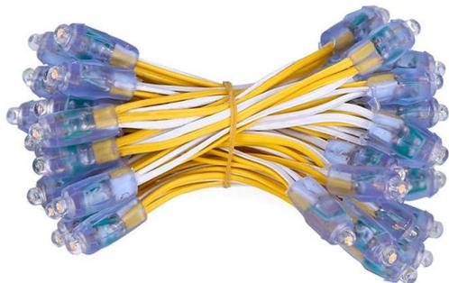
Tira con 50 unidades de Pixel LED de Ø12mm, cada módulo individual posee un LED EPISTAR color Blanco Cálido y un micro integrado. Con alimentación DC5V. Ideal para rotulación, decoración, señalización, etc. Su protección IP68 lo hace adecuado para su uso en exteriores.
